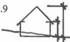
Bezugspunkt zum Messen der Trauf- und Firsthöhe im **GEE** ist das natürliche Gelände, das sich an das Gebäude an dem tiefsten Geländepunkt anschließt. (§ 18 Abs. 1 BauNVO)
