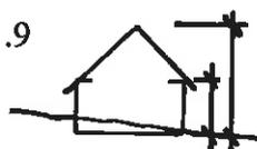
Bezugspunkt zum Messen der Trauf- und Firshöhe im **GEE** ist das natürliche Gelände, das sich an das Gebäude an dem tiefsten Geländepunkt anschließt. (§ 18 Abs. 1 BauNVO)
